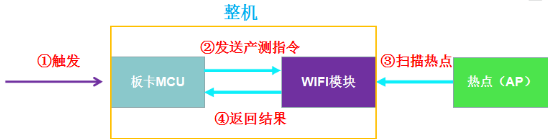
图 5.1 整机生产测试示意图
