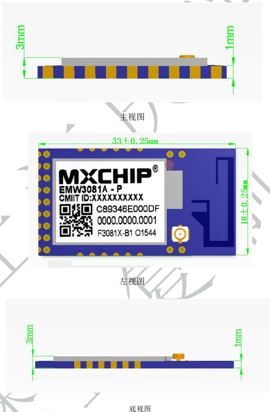
图 10 EMW3081A 三视图（单位：mm）
