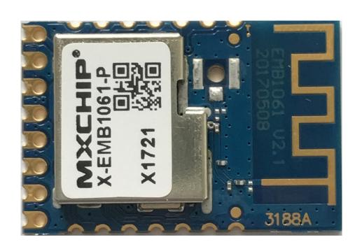
EMB1061是单3.3V供电的超低功耗嵌入式蓝牙模块,集成了一颗BLE4.2单模SOC,包含ARM Cortex-M0内核,BLE/2.4G Radio,24KB RAM,160KB Flash和丰富的外设资源。模块采用邮票口封装,方便调试和焊接。
